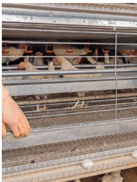
Automatický sběr vajec, kryt chrání vejce ve žlábků
